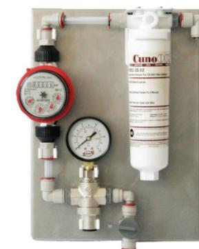
**Option:** Komfortfilterplatte mit Wasserzähler, Wasserdruckminderer, Absperrhahn und Kombifilter auf Edelstahlplatte montiert.
